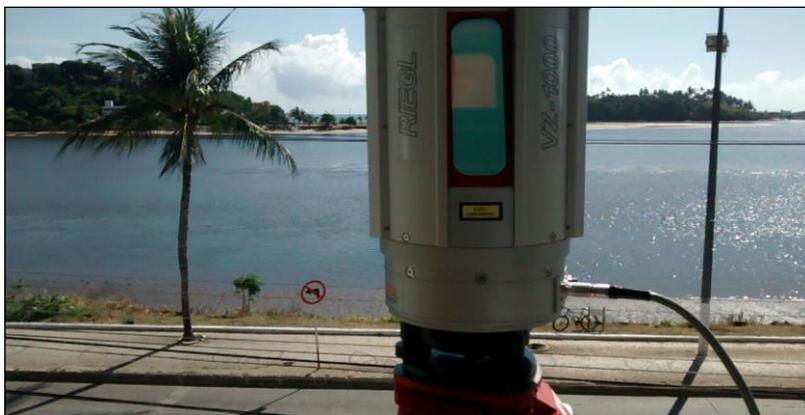
De acordo com Vogel *et al.* (2011), o *laser scanner* produz como resultado uma nuvem de pontos, a qual é a união de todos os pontos medidos num único sistema de coordenadas. Além das coordenadas XYZ, também é obtida a intensidade de retorno do *laser* para cada ponto, o que ajuda bastante a identificar elementos em campo em função do material e da cor. Outro fator é que a densidade de pontos deve ser adequada com o objetivo do trabalho, sendo que a nuvem de pontos permite a obtenção de
