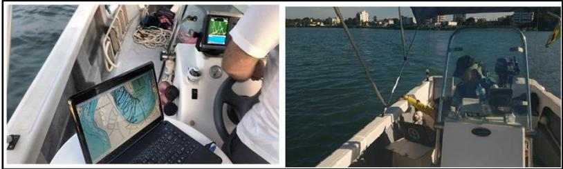
O levantamento batimétrico foi realizado no mês de junho de 2016. A malha amostral foi composta por aproximadamente 30.000 pontos, equidistantes em cerca de 10m e representativos de sessões transversais, abrangendo margem direita, canal e margem esquerda de toda a zona estuarina. Durante a tomada dos pontos batimétricos, a altura da maré era medida a cada 10 minutos pela régua de maré.
