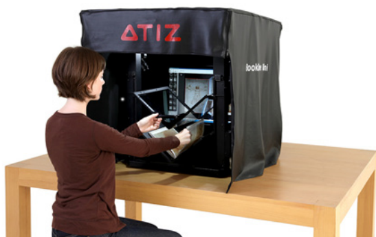
Abbildung 1: Buchscanner der Firma Atiz. Deutlich sichtbar die rechtwinklig montierten Glasscheiben, die die Buchseiten anpressen.
