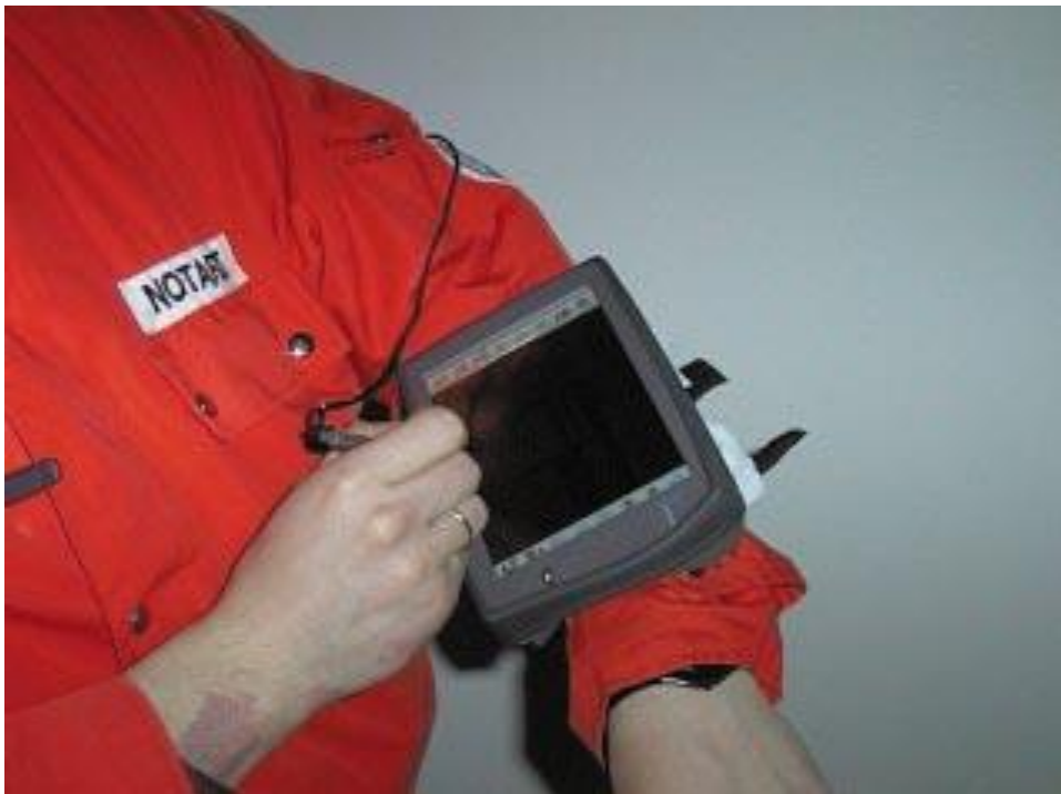
Abbildung 36: In die Bekleidung integrierter Xybernaut MA IV mit Bildschirm (Schächinger et al., 1999, S. 473)
