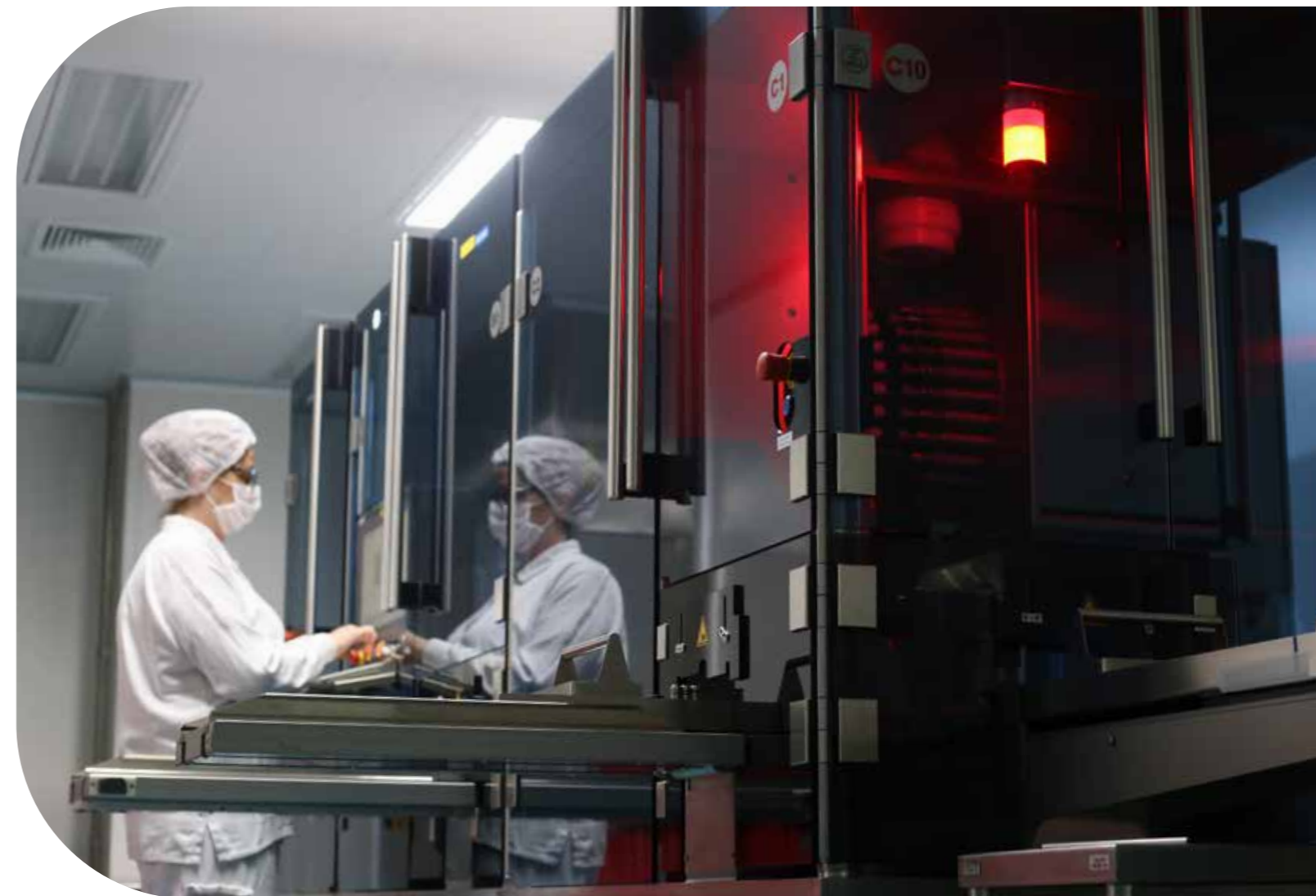
Máquina Revisora SEIDENADER MSDS-HVLD, com sistema automático integrado para revisão de produtos líquidos e liofilizados em ampolas e frascos-ampola.
