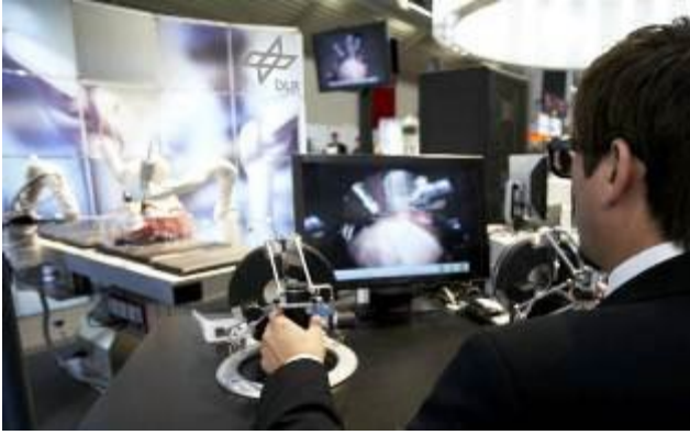
Abb. 1: DLR Telepräsenzscenario für MIRC „MIRO-Surge“. Bild links: im Vordergrund die Eingabestation für den Chirurgen, im Hintergrund das patientenseitige Chirurgierobotersystem. Bild rechts: Chirurgierobotersystem im Detail mit Endoskopführung und zwei Roboterarmen für bimanuelle Telemanipulation.
