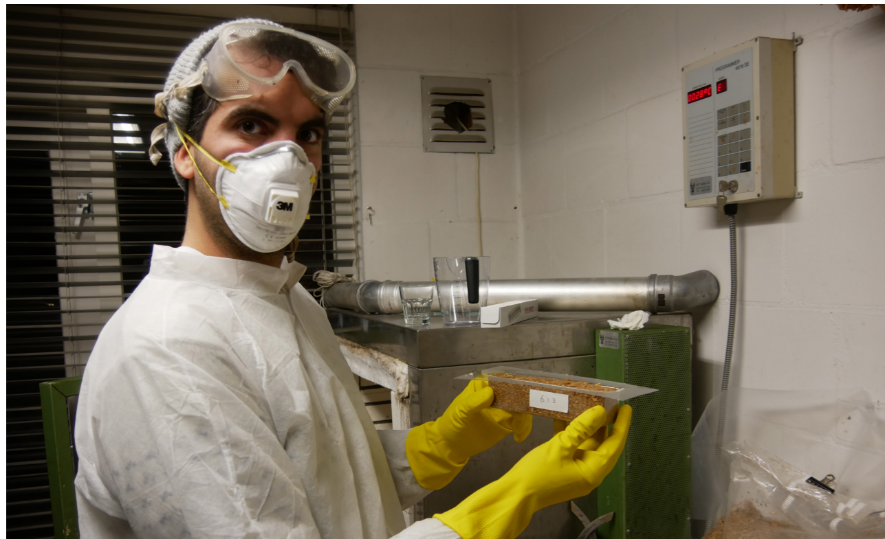
Ir. Bob Hendriks werkt met mycelium aan een proefopstelling 'wonen in een levende schimmel'.
