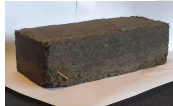
Pilot-recyclingsfaciliteit: bakstenen van 100% afvalplastic en zand.
