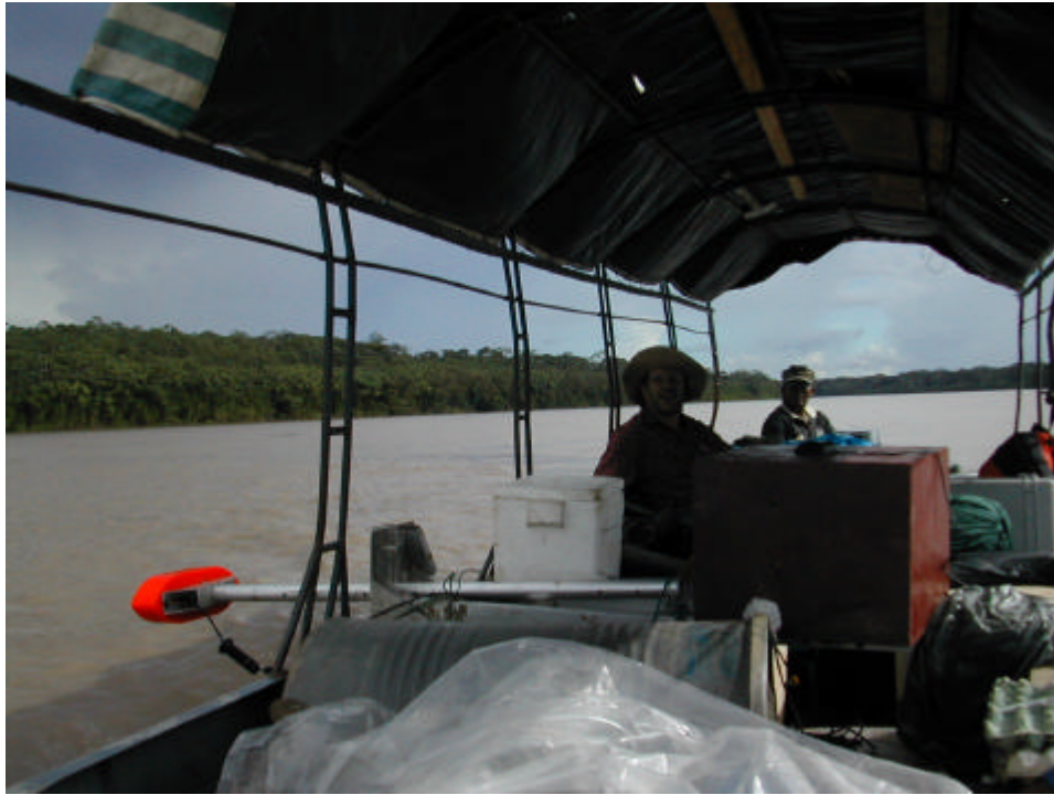
Figura 1 : Instalación de la ecosonda y GPS en el deslizador de la naval
