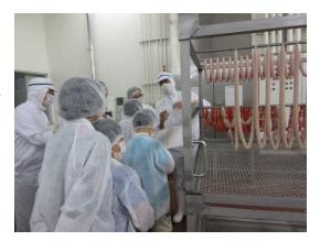
小さな鉄の粒を金属探知機にとおして、機械の反応を確認。
