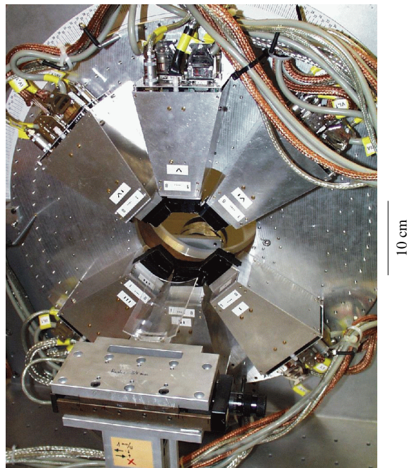
Abbildung 4.5: Anordnung der Detektormodule auf der rotierbaren Scheibe des MADPET
