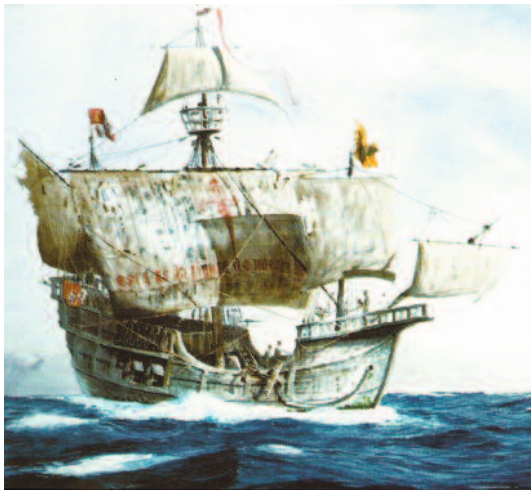
Nao Victoria . Acuarela de González Aledo. Se pueden ver los cintones, las bulárcamas y el ancla de estribor en su estiba. (Museo Naval de Madrid).
