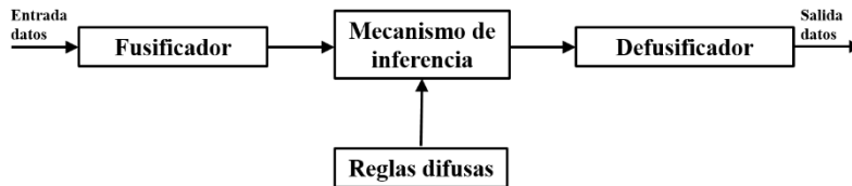
Fig. 1. Esquema general de funcionamiento de un sistema de inferencia difuso.
