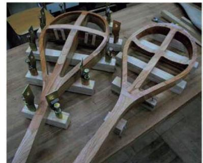
図4 収縮を妨げない開放型成形治具
