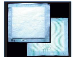
図 モデル吸収体の表と裏（10cm×10cmパルプ4g、高吸水性樹脂2gを混合し、ポリエチレンとポリオレフィン系（PE/PP）繊維の不織布で片面ずつ覆った）
