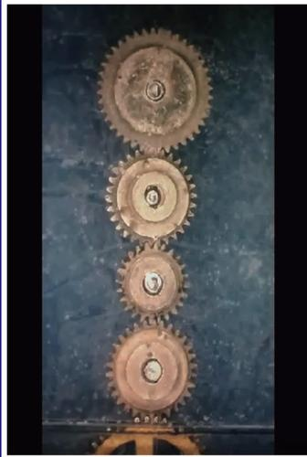
直径0.5~1.0mmのギアを4連結し時計のモーターで回転させるメカを作りました
