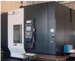
5軸制御立形マシニングセンタ等を用いた精密機械加工
