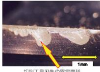
切削工具先端の異常摩耗
