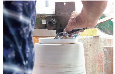
図1 機械ロクロ成形
