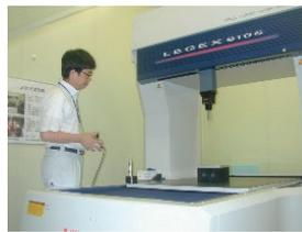
三次元測定機等を用いた機械計測
