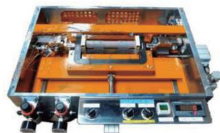
応力負荷型単板磁気試験器
