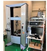
精密万能試験機等を用いた各種評価
