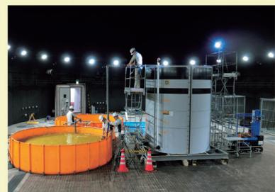
大型電気製品等の水没試験
