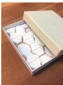
② 3Dプリントしたサンプルで菓子箱への組み込みを確認
