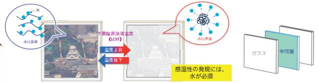
Fig. 3 温度応答性ポリマーを用いた合わせガラス
