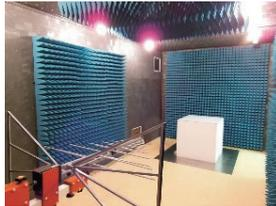
電磁妨害(EMI)試験機器
