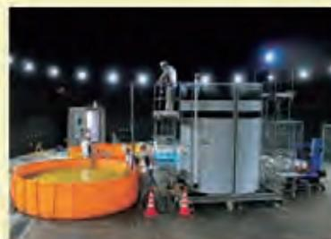
大型電気製品等の水没試験
