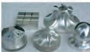
●5軸制御立形マシニングセンターによる試作加工例
