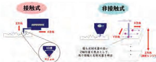
【図1】 接触式・非接触式測定機の測定方
