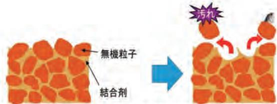
図1 想定する表面剥離型防汚材料の構造と防汚メカニズム
