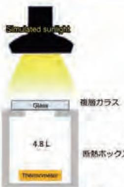
Fig. 6 擬似太陽光照射実験に用いた温度モニタリング装置。照射強度：53.8 kbx
