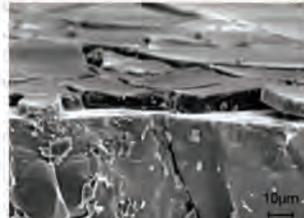
図2 缶内面塗料のSEM写真
