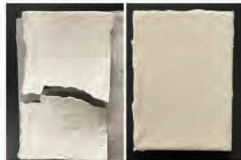
セルベンと高分子量ポリ乳酸の複合塗膜      セルベンとポリカプロラク톤の複合塗膜
