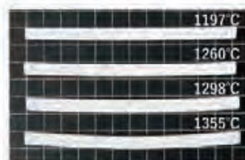
図1 焼曲げ試験結果
