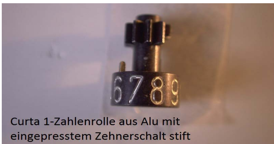
Abbildung 17: Neue Zahlenrolle aus Aluminium (Elmar Maier)
