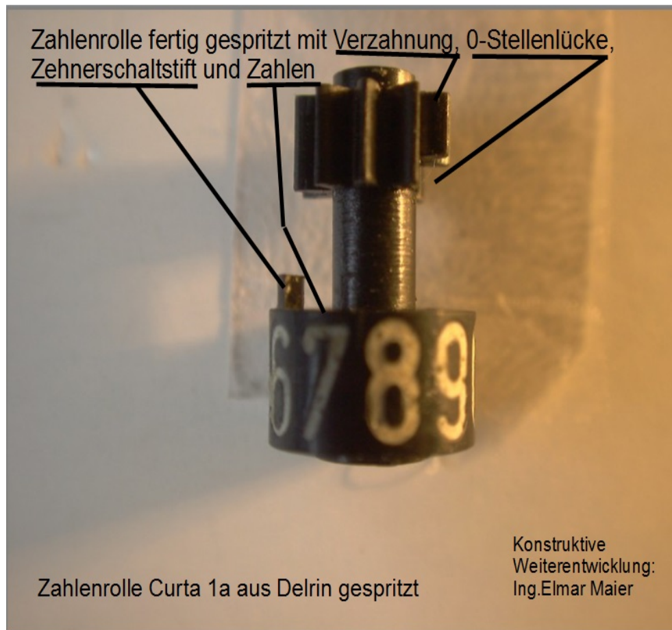
Abbildung 18: Zahlenrolle der Curta 1a aus Delrin (Elmar Maier)
