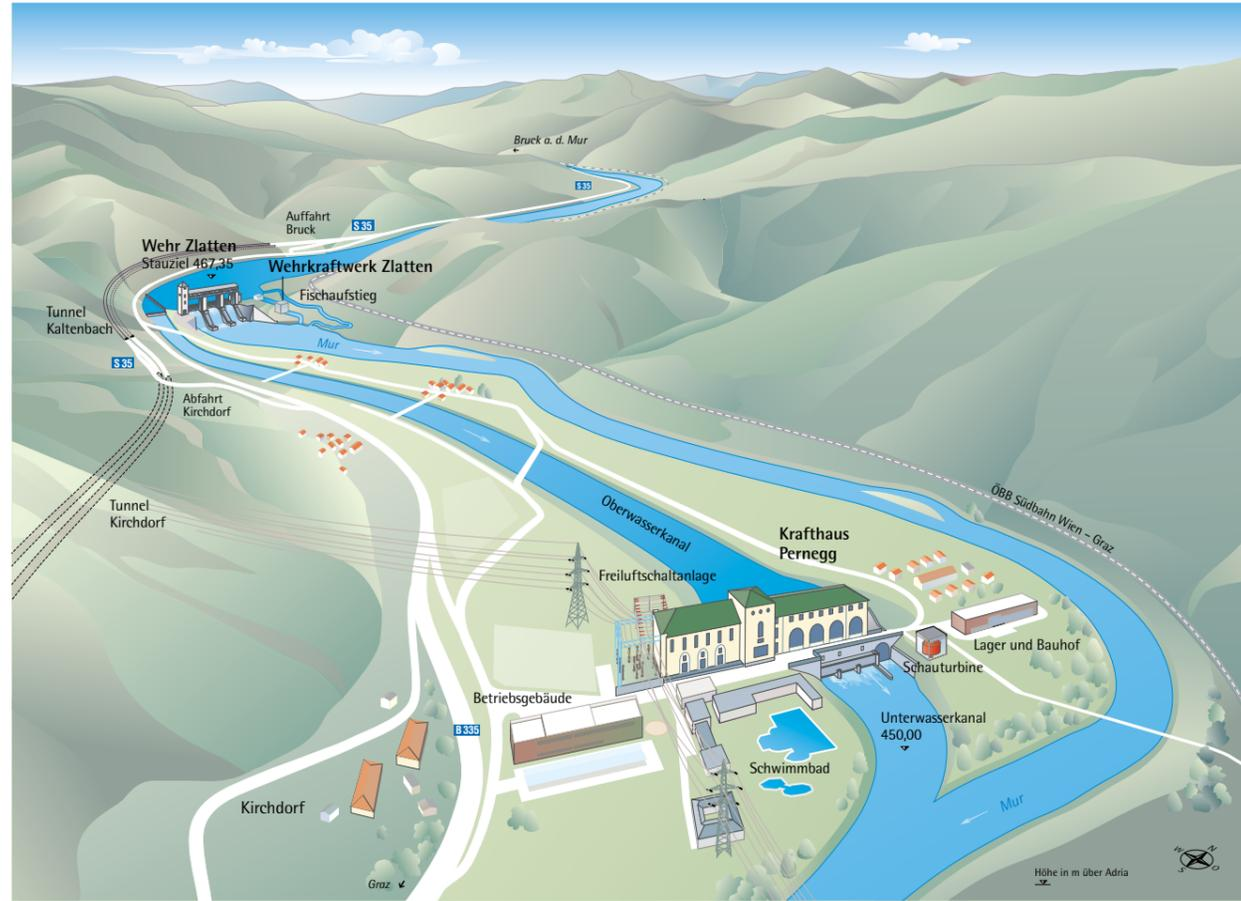
Kraftwerk Pernegg mit Wehr Zlaten, schematische Darstellung
