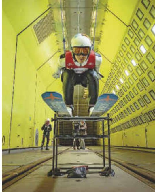
Beim Training im Windkanal suchen die Skispringer nach den optimalen Körperhaltungen für die Anfahrt (oben) und die Flugphase (links). Dafür werden sie von einem 90 Kilometer pro Stunde schnellen Wind angeblasen. Messungen des Luftwiderstands und des Auftriebs geben Aufschluss darüber, wie sich Änderungen der Sprungtechnik auf die Flugweite auswirken.
