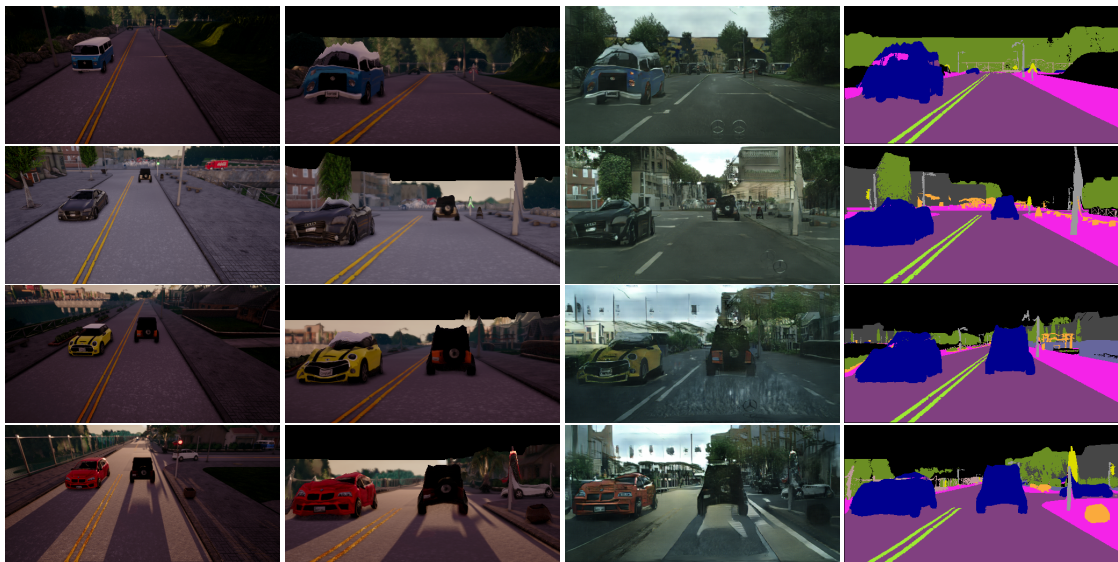
(a) Source Images (b) Warped Images (c) Refined Images (d) Warped Labels
